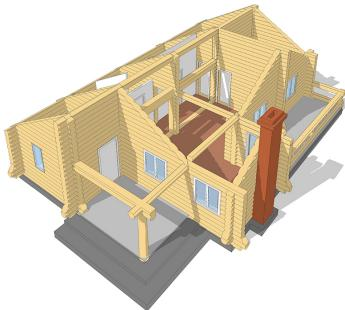
Это наиболее распространенный тип деревянного дома ручного исполнения. Соединения бревен здесь могут выполняться в полуокруглый или трапециевидный замок, в соединение типа «пасточкин хвост». Бревна могут иметь естественную форму, либо иметь срезанные плоскости (лафет) для формирования ровной поверхности стен.
